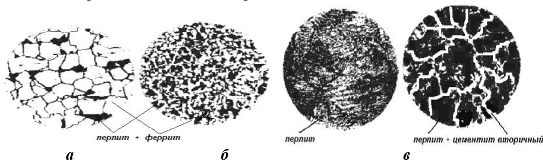
Рисунок 1. доэвтектоидная сталь 0,1% углерода (а), 0,4% углерода (б)
